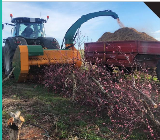
Broyeur récupérateur de bois pour atteler à des tracteurs de + de 300 CV jusqu'à 500 CV. Système de démarrage HIDRAHELP.
