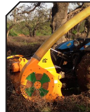
Dispositif d'andainage entraîné par une chaîne triple
