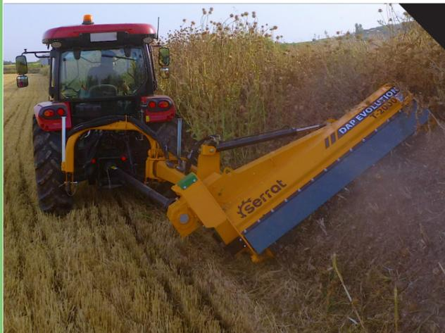
Broyeur haut de gamme pouvant travailler aussi bien aligné au tracteur que déporté sur le côté. Broyeur conçu pour l'entretien des talus, de bordures de champs, de chemins, des espaces verts ainsi que pour effectuer du broyage agricole. Broyeur conçu pour tracteurs compris entre 70 et 120 CV. Système de sécurité grâce à un clapet de positionné sur le piston au niveau du bras de déport du broyeur.
