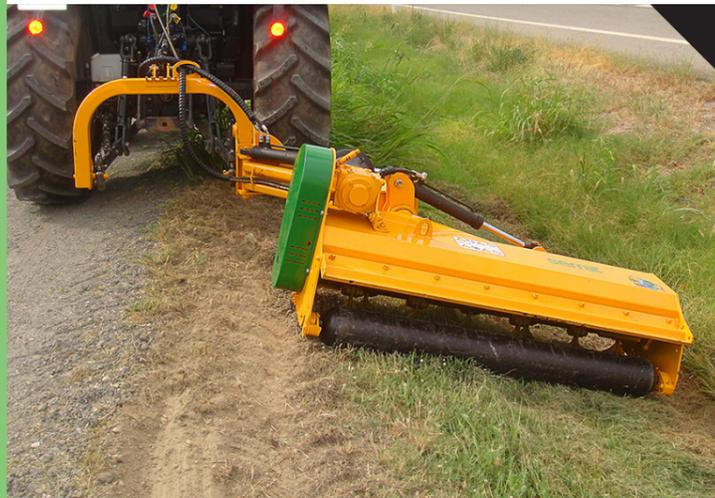
Broyeur conçu pour l'entretien des talus, de bordures de champs, de chemins et pour effectuer du travail agricole. La puissance nécessaire du tracteur est de 35 à 80 CV.
