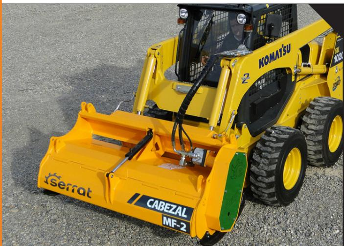
Broyeur à adapter sur les bras un mini chargeur jusqu'à 5 t, accouplé au circuit auxiliaire pour le broyage d'herbe, de roseaux et de branches jusqu'à 60 mm de diamètre.
