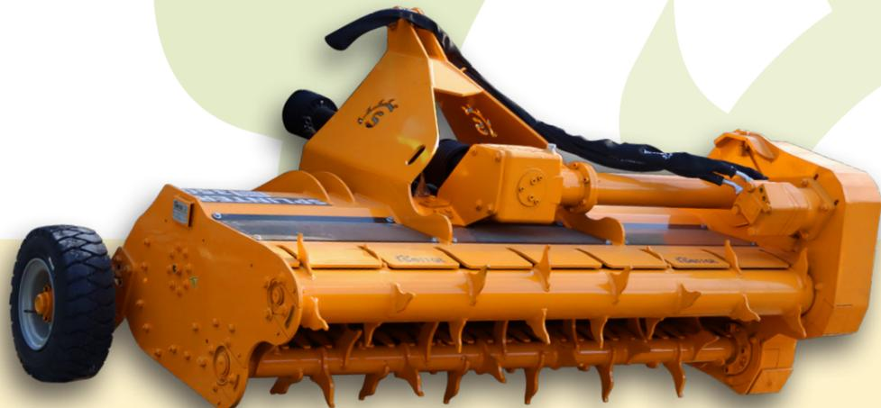
2 lignes de contre-couteaux boulonnées au châssis
