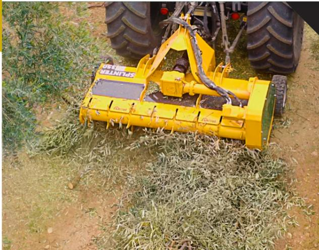
Broyeur hors sol muni d'un double système de pick-up hydraulique réversible et équipé d'un rotor SPLINTER de SERRAT conçu pour le bois de taille en arboriculture, oliviers, fruits secs, agrumes, jusqu'à 60 mm de diamètre et pour des tracteurs compris entre 60 et 120 CV.
