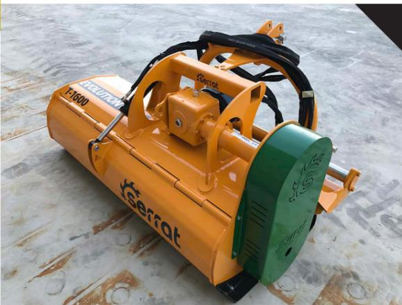
Broyeur conçu pour des tracteurs entre 60 CV et 120 CV de puissance pour l'entretien en arboriculture, refus de prairie, jachères, et bois de taille jusqu'à 80 mm de diamètre.
