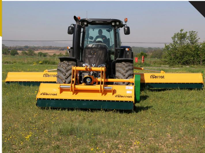
Composition pour tracteurs de grandes puissances, atteignant une largeur de 9,5 mètres de travail. Possibilité de repliage des broyeurs arrière afin de circuler sur route. Largeur hors-tout replié au transport: 3 m. A l'avant du tracteur est monté un broyeur de 3 m afin d'éviter que le tracteur ne roule sur la matière à broyer. Son usage est dirigé au broyage de pâturages et à l'agriculture en général (maïs, coton) ou au broyage d'herbe de prairie, des aéroports, etc.
