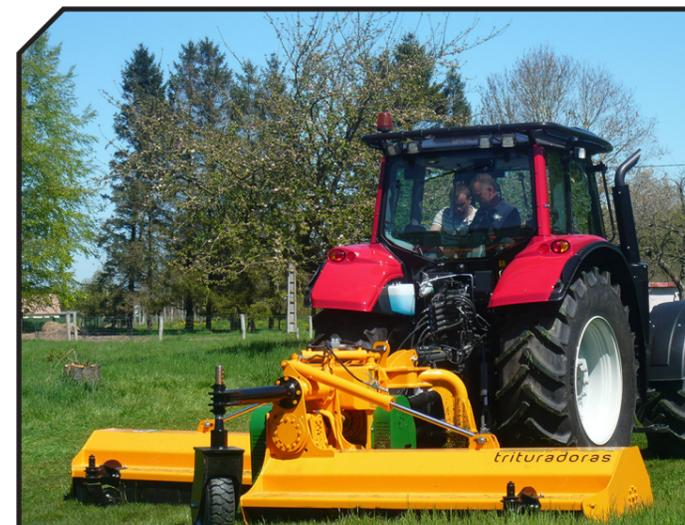
Repliable par vérin hydraulique
