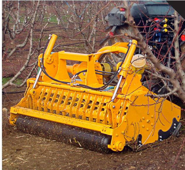
Broyeur polyvalent pour le broyage de résidus de taille et des zones herbagées. Ce broyeur permet de travailler dans les deux sens (en marche avant ou en marche arrière).
