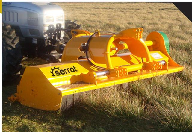
Broyeur équipé de marteaux forgés SERRAT, conçu pour l'élimination des résidus de tailles jusqu'à 80 mm de diamètre et la maintenance des zones herbagées. Idéal pour la régénération des prairies et des espaces verts. Rotor POLSER de 450-500 mm de diamètre. Sa composition réversible et déplaçable permet d'actionner la machine depuis le relevage avant ou sur le relevage arrière pour des tracteurs réversibles, en évitant de rouler sur le matière à broyer.
