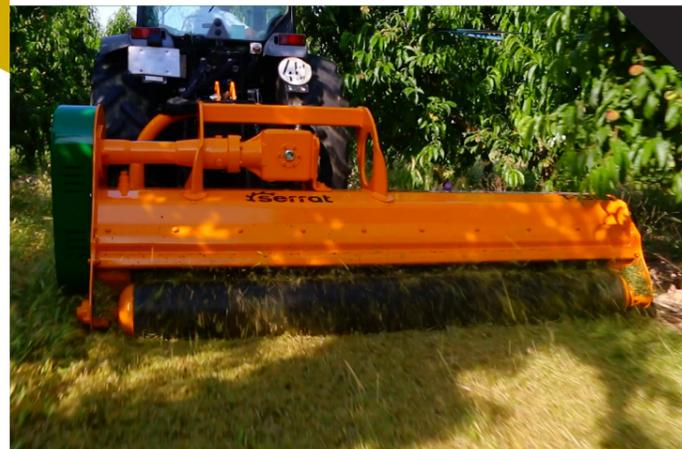
Broyeur équipé de marteaux forgés SERRAT, conçu pour l'élimination des résidus de tailles jusqu'à 80 mm de diamètre et la maintenance des zones herbagées.
