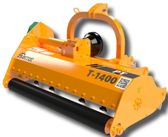
Broyeur conçu pour des tracteurs entre 20 CV et 40 CV de puissance pour l'entretien en arboriculture, refus de prairie, jachères, et bois de taille jusqu'à 30 mm de diamètre.
