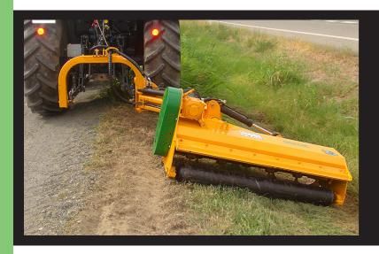
Broyeur conçu pour l'entretien des talus, de bordures de champs, de chemins et pour effectuer du travail agricole. La puissance nécessaire du tracteur est de 35 à 80 CV.
