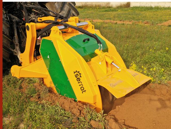
Machine pour la préparation du sol jusqu'à une profondeur de 400-500 mm, pour tracteurs entre 200 et 350 CV.
