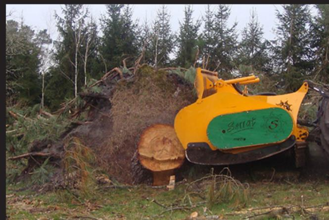
Broyeur forestier adapté pour des tracteurs standards de 300 à 600 CV.
