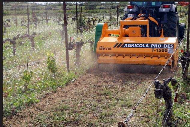
Ce broyeur s'utilise pour broyer du bois de tailles, des résidus de cultures ainsi que pour le nettoyage des terrains en jachères ou des prairies. C'est un broyeur universel fiable et performant. Rotor POLSER de 550 mm de diamètre pouvant broyer du bois de 100 à 120 mm de diamètre. Sa configuration déplaçable déporte latéralement de 325-450 mm de l'axe de travail grâce à un vérin hydraulique.
