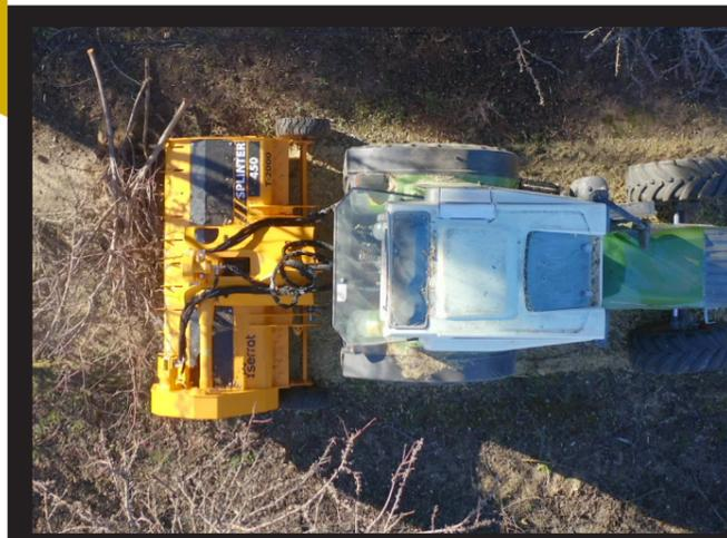
Broyeur hors sol muni d'un double système de pick-up hydraulique réversible et équipé d'un rotor SPLINTER de SERRAT conçu pour le bois de taille en arboriculture, oliviers, fruits secs, agrumes, jusqu'à 100 mm de diamètre et pour des tracteurs compris entre 90 et 170 CV.
