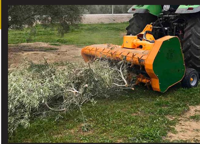
Broyeur hors sol muni d'un double système de pick-up hydraulique réversible et équipé d'un rotor ÓCLAME de SERRAT conçu pour le bois de taille en arboriculture, oliviers, fruits secs, agrumes, jusqu'à 8-10cm de diamètre et pour des tracteurs compris entre 90 et 140CV.
