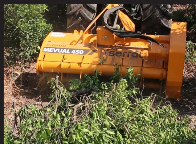
Broyeur hors sol muni d'un double système de pick-up hydraulique réversible et équipé d'un rotor ÓCLAME de SERRAT conçu pour le bois de taille en arboriculture, oliviers, fruits secs, agrumes, jusqu'à 8cm de diamètre et pour des tracteurs compris entre 70 et 110 CV.
