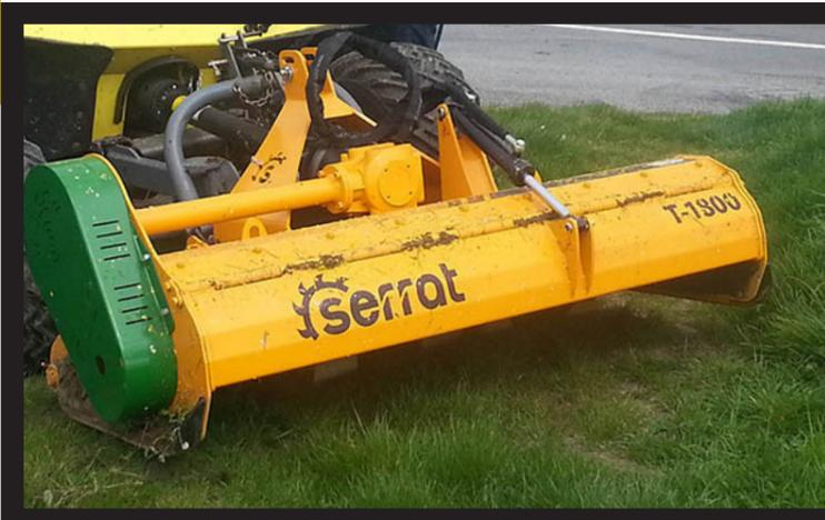
Broyeur conçu pour des tracteurs entre 40 CV et 80 CV de puissance pour l'entretien en arboriculture, refus de prairie, jachères, et bois de taille jusqu'à 50 mm de diamètre.
