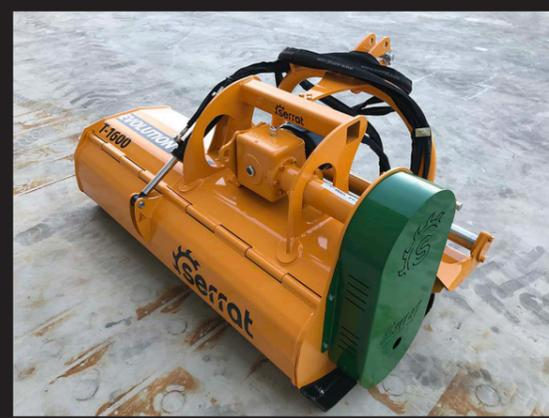
Broyeur conçu pour des tracteurs entre 60 CV et 120 CV de puissance pour l'entretien en arboriculture, refus de prairie, jachères, et bois de taille jusqu'à 8 cm de diamètre.
