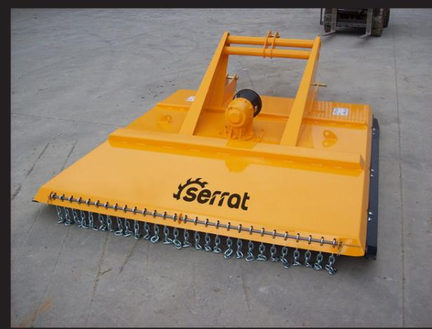
Broyeur à chaîne pour effectuer des travaux forestiers, d'entretien en jardinerie et de maintenance agricole pour des tracteurs de 50 à 80 CV.
