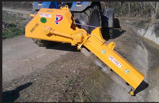
Broyeur professionnel conçu pour l'entretien des talus, de bordures de champs, de chemins et pour effectuer du travail agricole. Il peut broyer des branches jusqu'à 12 cm de diamètre. Transmission de la puissance à l'aide de 3 boîtiers avec un système de sécurité mécanique. Angulation: +90° / -60° Possède un rotor POLSER de 550 mm de diamètre de coupe.
