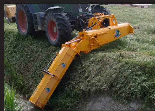
Broyeur conçu pour le secteur professionnel afin d'effectuer l'entretien des bordures de champs ou de routes, capable de broyer des branches jusqu'à 8 cm de diamètre.
