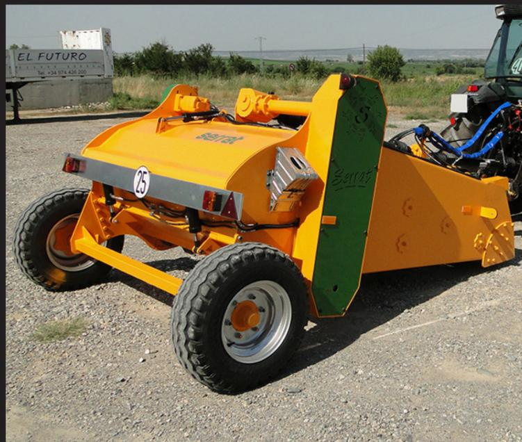
Broyeur de pierres avec système d'alimentation continue pour le calibrage de terrains à usage agricole et horticole.
