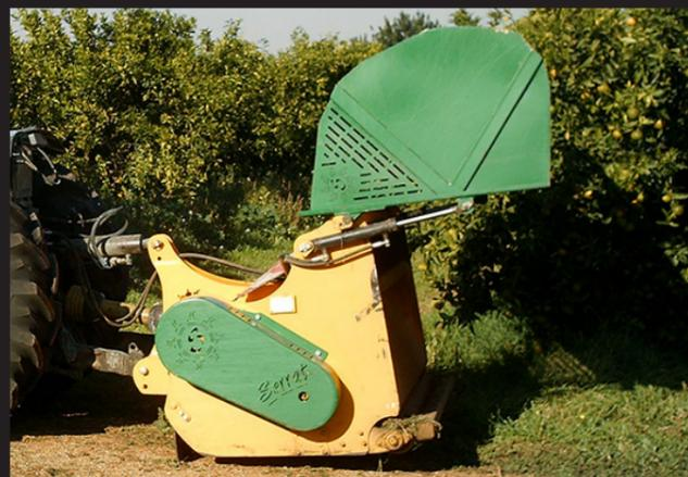
Broyeur adapté pour le broyage et la récupération de l'herbe et des branches jusqu'à 80 mm de diamètre.
