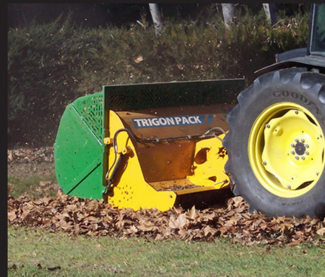
Broyeur adapté pour le broyage et la récupération de l'herbe et des branches jusqu'à 4 cm de diamètre. Entretien de jardins, piscines, équipements sportifs de plein air, etc. Grande capacité d'aspiration pour le ramassage de feuilles et de toutes sortes de débris (canettes, papiers, bouteilles en plastique, sacs, etc.) Equipé de marteaux forgés garantis contre cassure et de trémie de déchargement.
