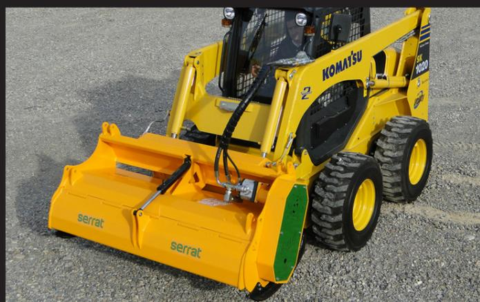
Broyeur à adapter sur les bras un mini chargeur jusqu'à 5 tn, accouplé au circuit auxiliaire pour le broyage d'herbe, de roseaux et de branches jusqu'à 3 cm de diamètre.
