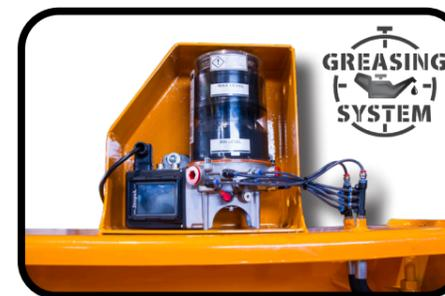
▶ Graissage centralisé
