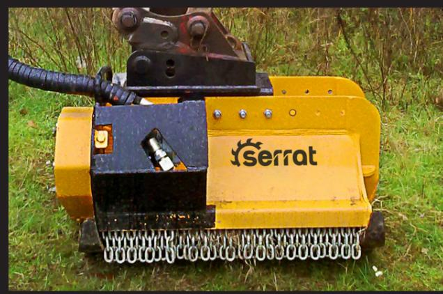
Tête adaptable sur des bras d'épareuses forestières et des pelles mécaniques de 6 à 15 tonnes.
