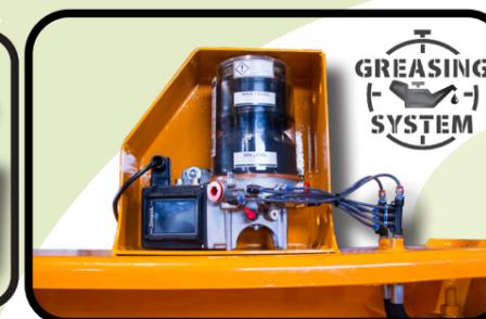
▶ Graissage centralisé
