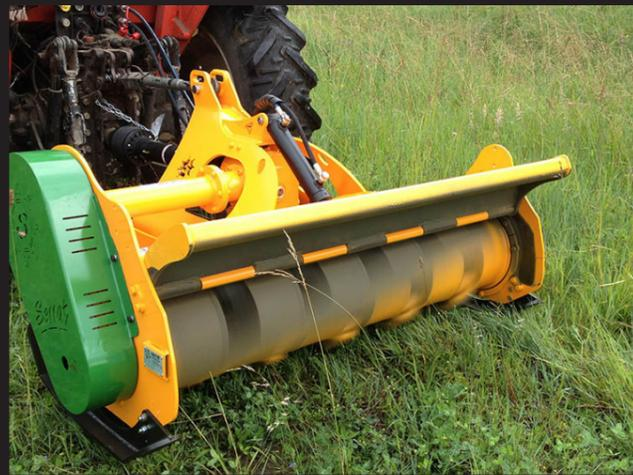
Broyeur forestier adapté pour des puissances de tracteurs standards ou à chenilles de 50 à 110 CV. Ce broyeur permet la maintenance de sous bois, de clairière, de chemin pédestre, de coupe feu, etc. C'est un broyeur haut de gamme utilisé par l'industrie des paysagistes.
