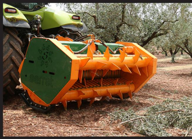
Broyeur muni d'un pick-up de ramassage à entraînement hydraulique réversible pour tracteurs compris entre 220 et 350 CV, idéal pour broyer de grandes quantités de branches de diamètre inférieur à 250mm. Broyeur qui peut effectuer un travail exigeant, où le broyage très fin de la matière est une obligation afin de l'aider à sa décomposition, ou bien pour les processus mécaniques qui suivent le broyage. Equipé d'un rotor à couteaux RHENDUEL, de conception SERRAT.
