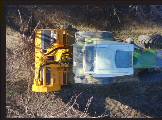
Broyeur hors sol muni d'un double système de pick-up hydraulique réversible et équipé d'un rotor SPLINTER de SERRAT conçu pour le bois de taille en arboriculture, oliviers, fruits secs, agrumes, jusqu'à 8cm de diamètre et pour des tracteurs compris entre 70 et 140 CV.
