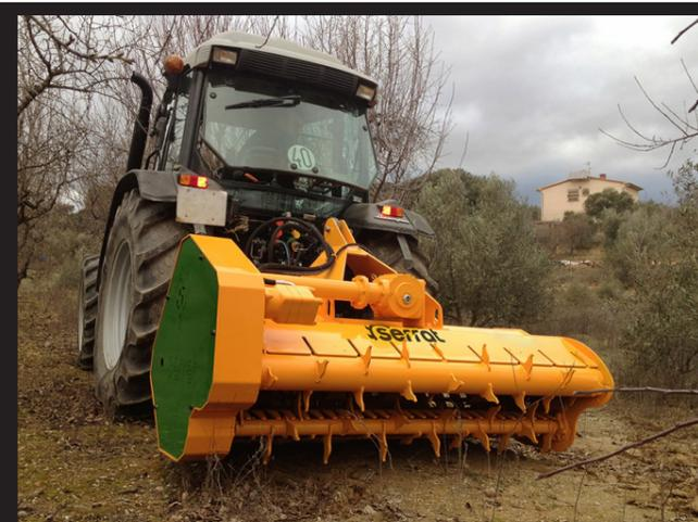
Broyeur muni d'un double pick-up hydraulique réversible conçu pour le broyage des résidus du bois de taille d'oliviers d'arbres fruitiers et de fruits secs de 6 à 8 cm de diamètre. Ce broyeur dispose d'un crible arrière interchangeable afin d'ajuster la granulométrie de la matière broyée.
