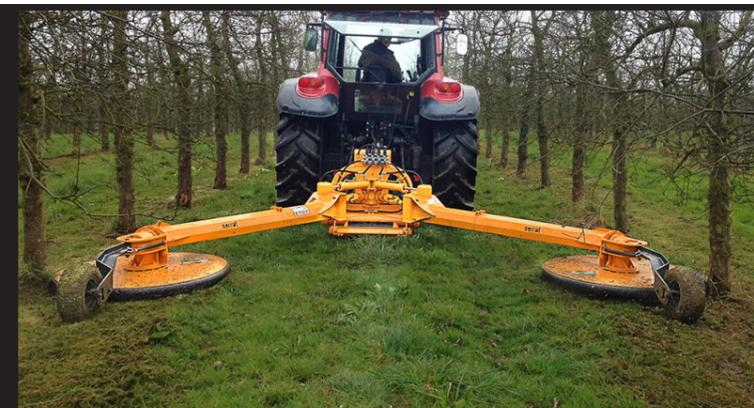
Double broyeur satellite à axe vertical et à entraînement mécanique conçu pour l'entretien au pied des arbres en vergers. Transmission mécanique par prise de force pour tracteurs compris entre 70 et 105 CV. Broyeur nous permettant de maîtriser le développement de l'herbe au pied des arbres, en un seul passage nous faisons l'entretien sous deux rangs. Notre broyeur nécessite 3 distributeurs hydrauliques:
