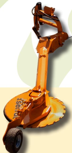
Contrôle par suspension hydropneumatique de poussée (réglable).
