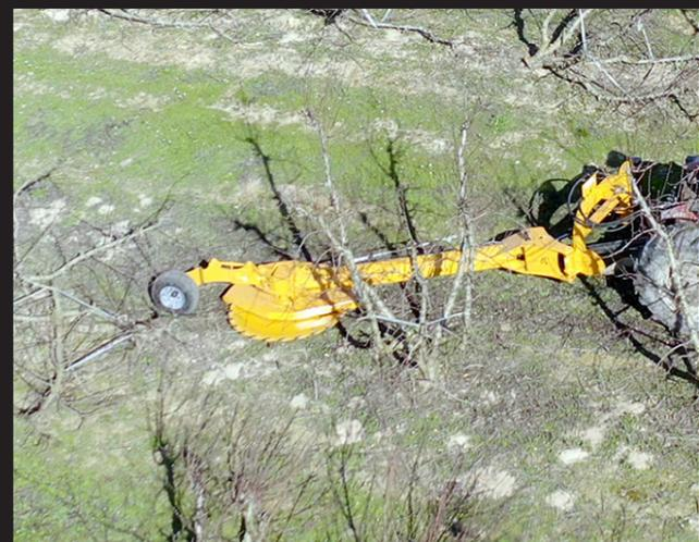
Disque à axe vertical et entraînement mécanique pour couper les troncs d'arbres fruitiers, jusqu'à 150 - 200 mm de diamètre.
