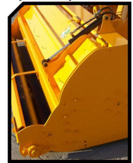
Protection anti fil de fer pour les roulements du rotor
