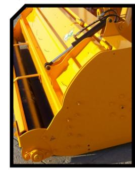
Protection anti fil de fer pour les roulements du rotor
