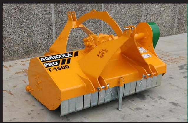
Ce broyeur s'utilise pour broyer du bois de tailles, des résidus de cultures ainsi que pour le nettoyage des terrains en jachères ou des prairies. C'est un broyeur universel fiable et performant. Rotor POLSER de 550 mm de diamètre pouvant broyer du bois de 10 à 12 cm de diamètre. Sa configuration réversible permet de protéger le tracteur de crevaisons et d'avaries vu qu'il n'a pas à rouler sur la matière à broyer. Conçu pour des tracteurs réversibles ou avec prise de force à l'avant.
