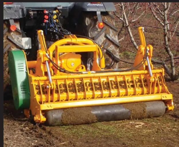
Broyeur polyvalent avec déport hydraulique pour le broyage de résidu de taille et des zones herbagées.
