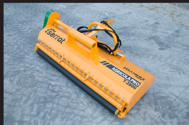
Ce broyeur s'utilise pour broyer du bois de tailles, des résidus de cultures ainsi que pour le nettoyage des terrains en jachères ou des prairies. C'est un broyeur universel fiable et performant. Rotor POLSER de 550 mm de diamètre pouvant broyer du bois de 10 à 12 cm de diamètre. Sa configuration déplaçable déporte latéralement de 325-450 mm de l'axe de travail grâce à un vérin hydraulique.
