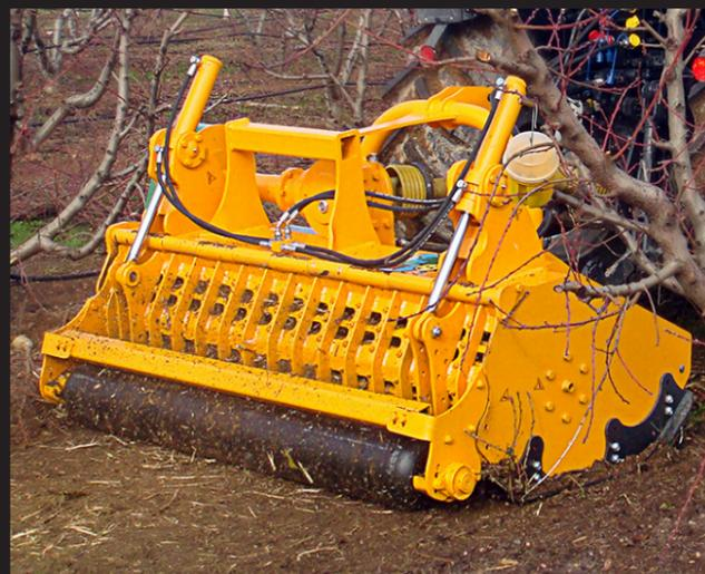
Broyeur polyvalent pour le broyage de résidus de taille et des zones herbagées. Ce broyeur permet de travailler dans les deux sens (en marche avant ou en marche arrière).
