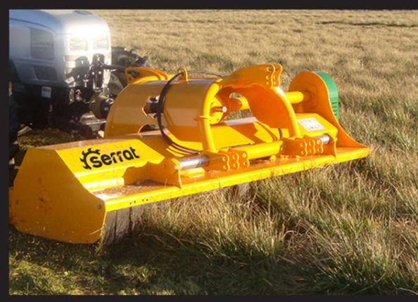
Broyeur équipé de marteaux forgés SERRAT, conçu pour l'élimination des résidus de tailles jusqu'à 8 cm de diamètre et la maintenance des zones herbagées.
