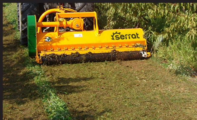
Broyeur équipé de marteaux forgés SERRAT, conçu pour l'élimination des résidus de tailles jusqu'à 8 cm de diamètre et la maintenance des zones herbagées.
